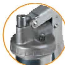
Смазочный шприц со стандартным клапаном для удаления воздуха
